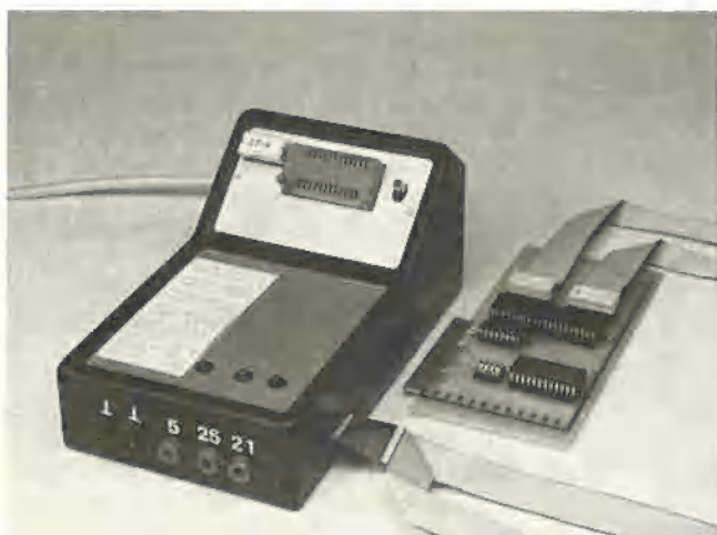
Foto 1: EPROM-Gerät im Gehäuse
